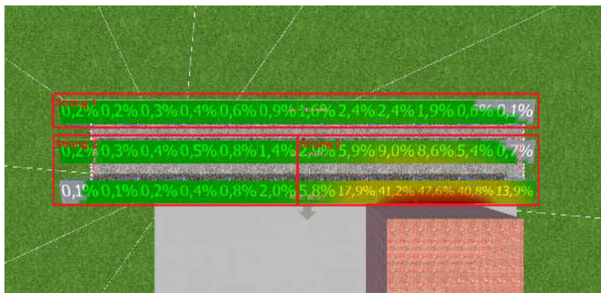
Abbildung 5-10 Verschaltung der Stränge auf dem Flachdach (abgeänderter Screenshot von [3])
