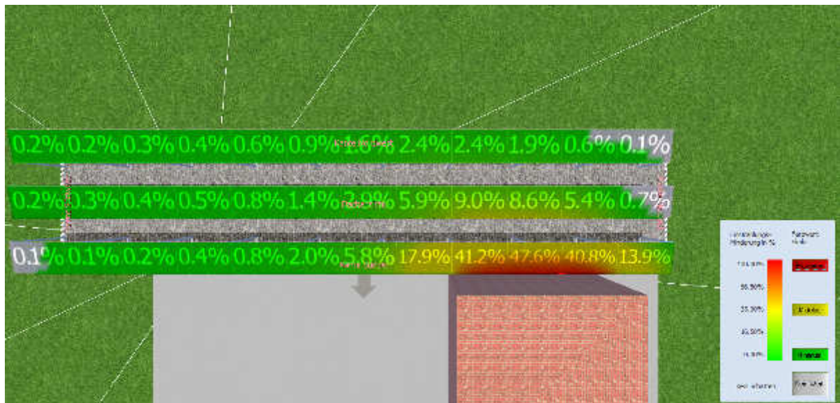
Abbildung 5-8 Verschattungshäufigkeit auf den Modulen bei Azimut -35°, Neigungswinkel 12°, liegende Montage und einem Gestellabstand von 0,7 m (Screenshot [3])
